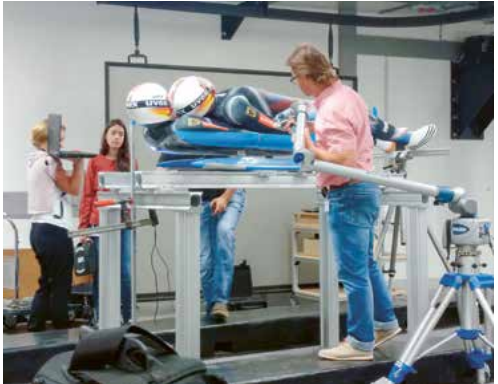
Taktile Abtastung für die Aerodynamik-Simulation
