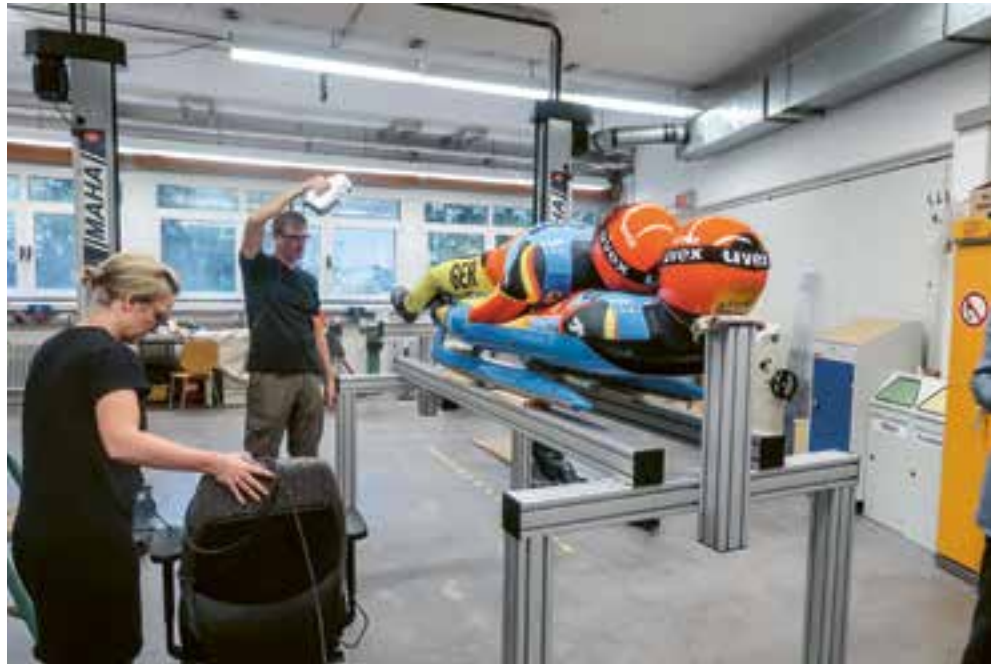
3D-Scan für die Aerodynamik-Simulation
